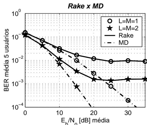
Figura 8. Desempenho dos receptores RAKE e MD, em função da relação  $E_b/N_o$  considerando um canal multipercursos com distribuição Rayleigh e perfil de energias exponencial.
