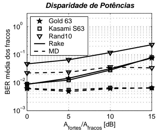
Figura 12. Desempenhos dos receptores RAKE e MD diante de situações de disparidade de potências, considerando  $E_b/N_0 = 10dB$  e canal com dois percursos com distribuição Rayleigh e perfil exponencial de energias.
