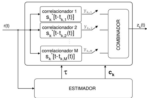
Figura 6. Configuração básica de um receptor RAKE para o  $k$ -ésimo usuário.
