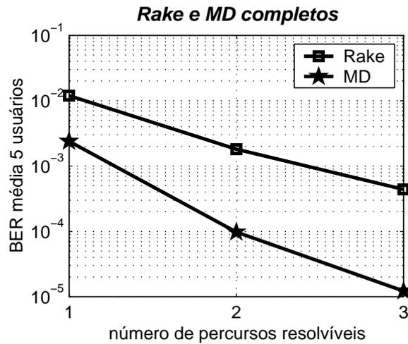
Figura 10. Desempenhos do RAKE e MD completos com combinador EGC, considerando  $E_b/N_0 = 20dB$  e canal multipercursos com distribuição Rayleigh e perfil exponencial de energias.
