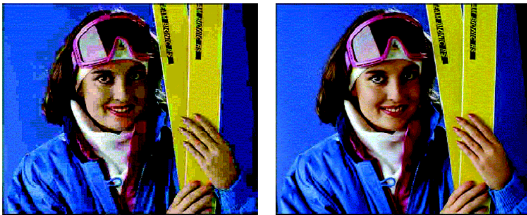
Fig. 5.5 – Imagens codificadas pelos processos JPEG (esq.) e JPEG 2000 (dir.), à taxa de 0,25 bits por pixel
