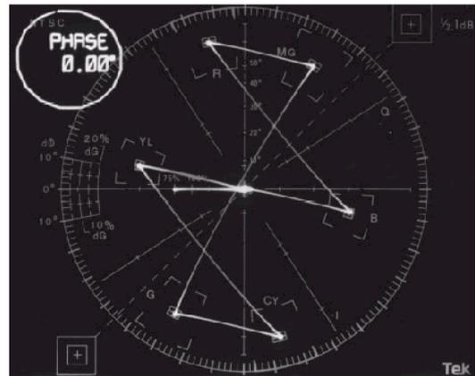
**Fig. 10.2 - Sinal de Barras Coloridas em Vetorscópio**
