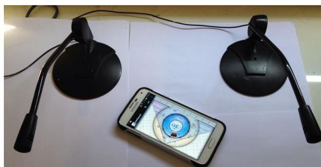
Figura 17 – Arranjo de Microfones e Aplicativo de Celular
