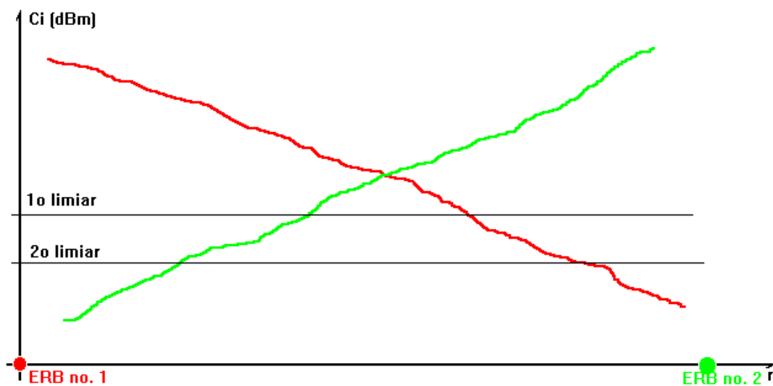
Figura 2.9 Ilustração de um handoff. No gráfico, r representa a distância de uma estação móvel em relação à ERB nº 1. A célula nº 2 é adjacente à célula nº 1.
